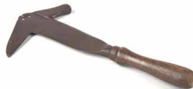
Leidekkershamer uit de eerste helft van de 20ste eeuw, met zijn kenmerkende scherpe punt aan de ene zijde voor het slaan van de gaten voor spijkers en aan de andere zijde een platte kop om de spijkers in de gaten te hameren. Het gaatje in het blad wordt gebruikt om spijkers uit te trekken. Met het metalen deel boven het houten handvat worden de leien op maat gemaakt. (Nederlands Openluchtmuseum)
